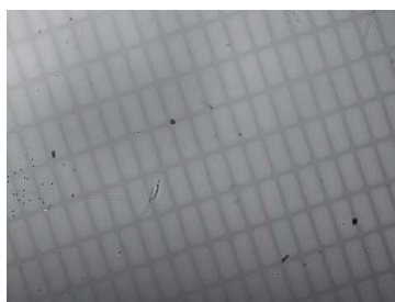
明視野同軸落射 LEDスポット照明(1050nm)
