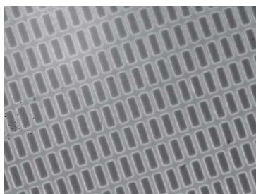
暗視野 LEDリング照明(1450nm)
